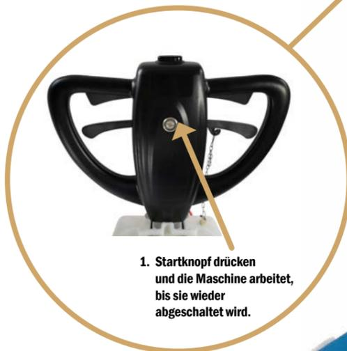
1. Startknopf drücken und die Maschine arbeitet, bis sie wieder abgeschaltet wird.
